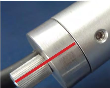
**Abb. 16:** Markierung Anti-Skating Schraube
